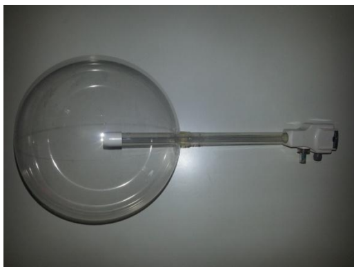
Figura 43. Balão OMSPDB 1000 ® da Covidien ® inflado até 5.000 ml de ar sem ruptura.
