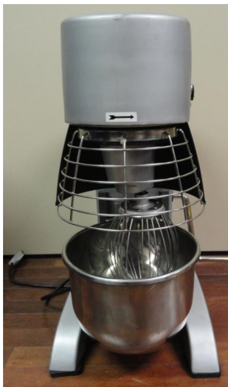
Figura 21 - Bacia da batedeira desprovida de dispositivo de manuseio ou alças.
