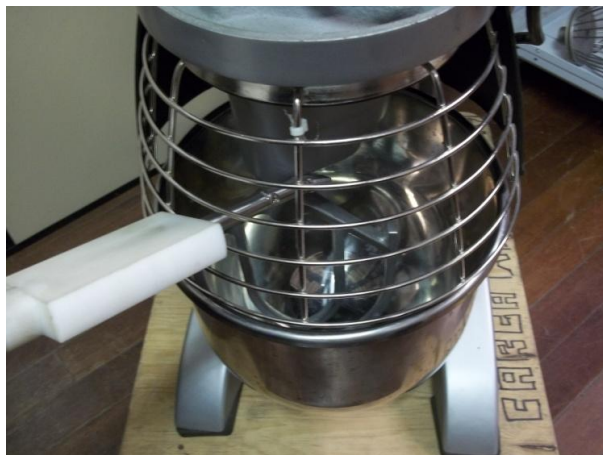
Figura 07 - Acesso à região de processamento com dedo de prova.
