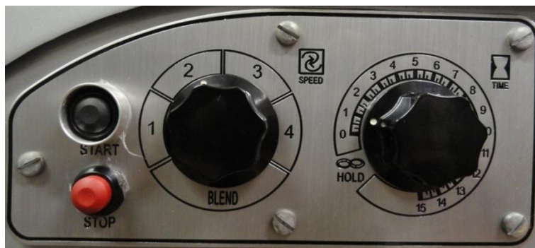
Figura 20 - Máquina desprovida de sistema de reset manual.
