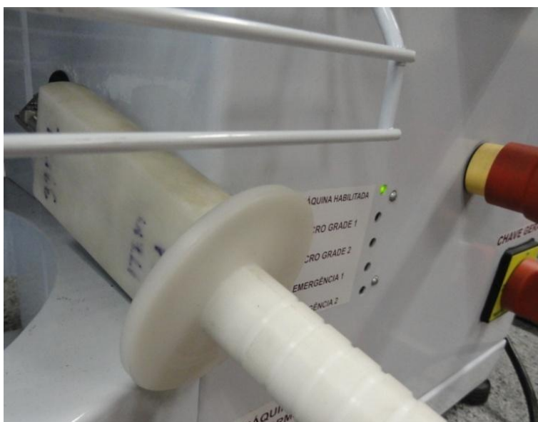
Figura 19 - Dedo padrão de ensaio liberando o intertravamento e habilitando a máquina para entrar em funcionamento mesmo sem a bacia.
