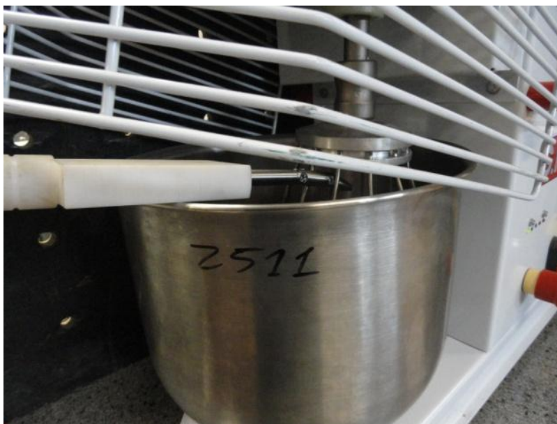
Figura 13 - Acesso ao batedor por baixo da grade de proteção.
