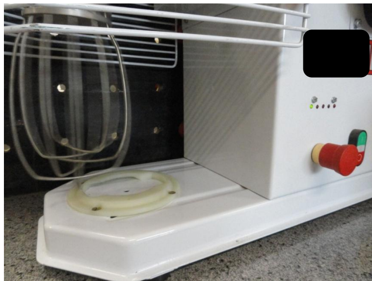
Figura 22 - Acesso a zona de perigo sem eliminação do risco.
