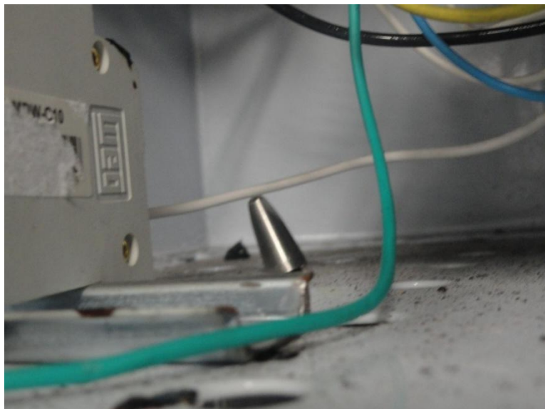
Figura 16 - Detalhe do dedo padrão acessando a isolamento básica da fiação interna através da abertura na base.
