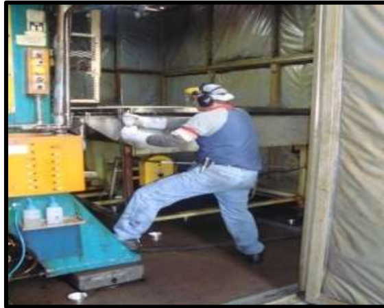
Figura 37 – Passagem da emenda pelo die set
