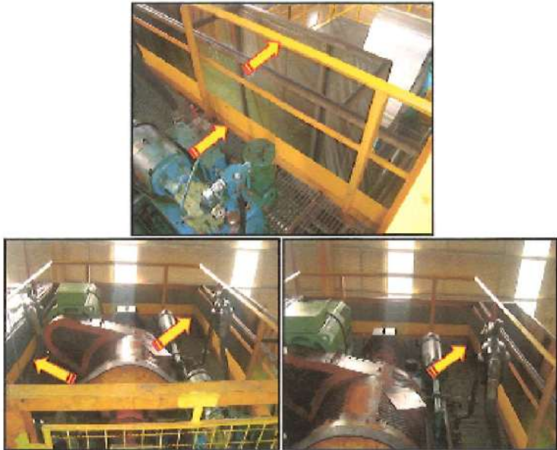
Figura 26 – Travessão superior e rodapés
