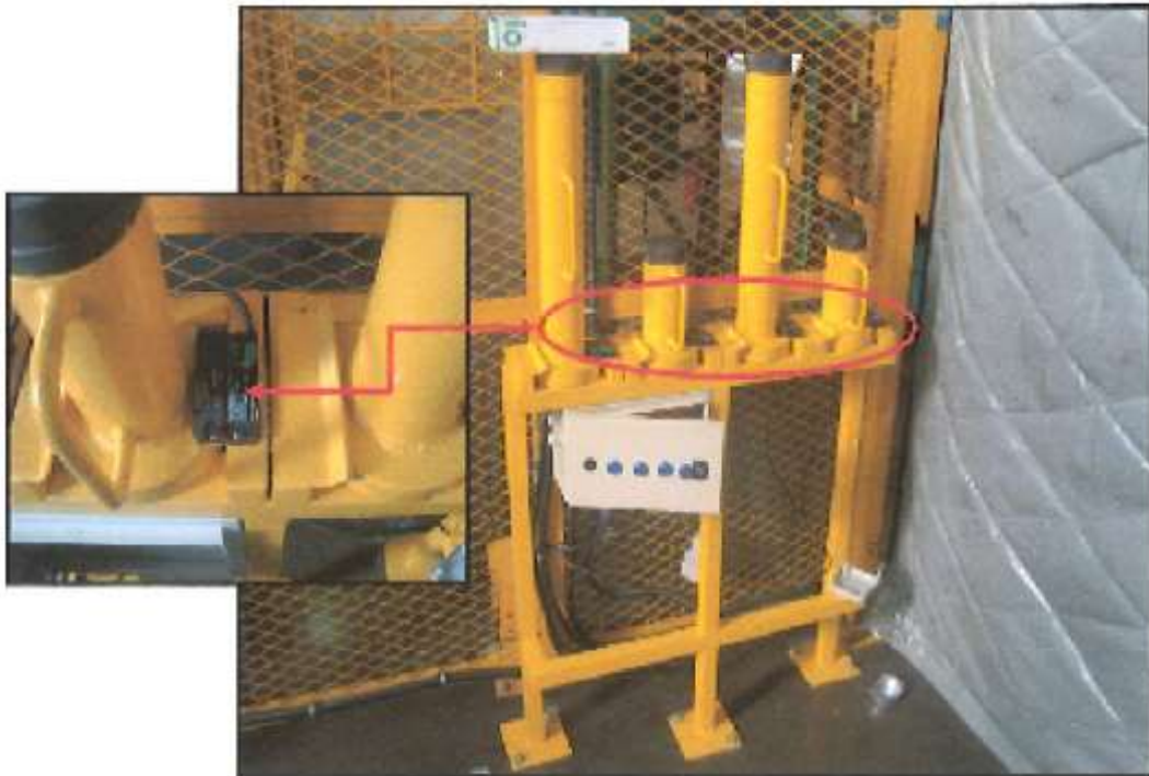
Figura 27 – Calços de segurança monitorados por chave magnética
