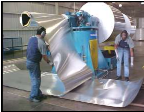
Figura 32 – Desenrolando a bobina
