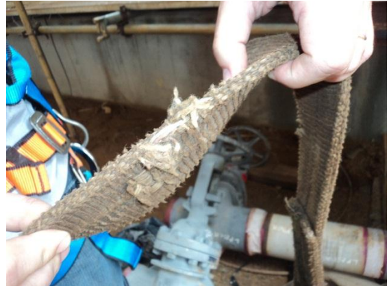
Figura 19: Cintas de Elevação
