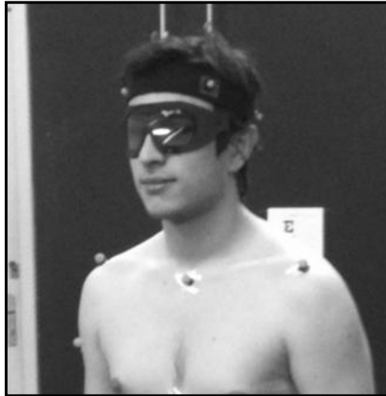
Figura 4. Máscara com película automotiva para redução do nível de luz.
