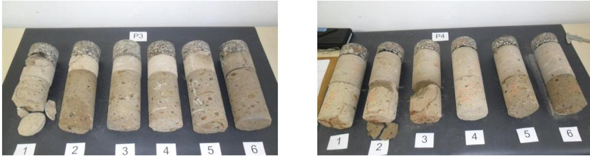
Figura 5.5 - Conjunto das amostras extraídas nos pontos P3 e P4.
