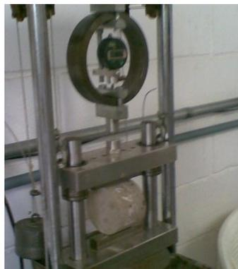
Figura 3.14 – Prensa utilizada na determinação da RCD.
