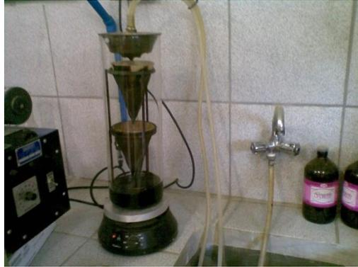
Figura 3.16: Equipamento para determinação do teor de CAP.
