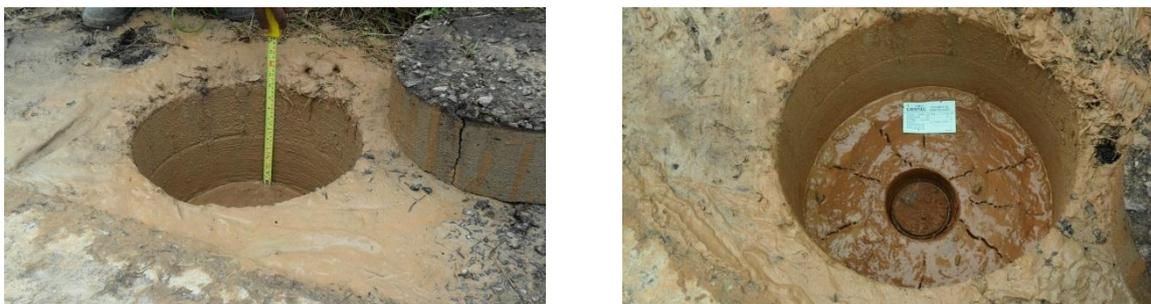
Figura 5.9 – Sondagem no acostamento estaca 3 + 040.
