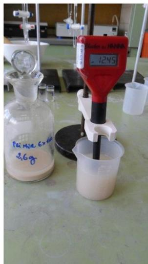
Figura 3.22 – Equipamento utilizado para determinação do pH.
