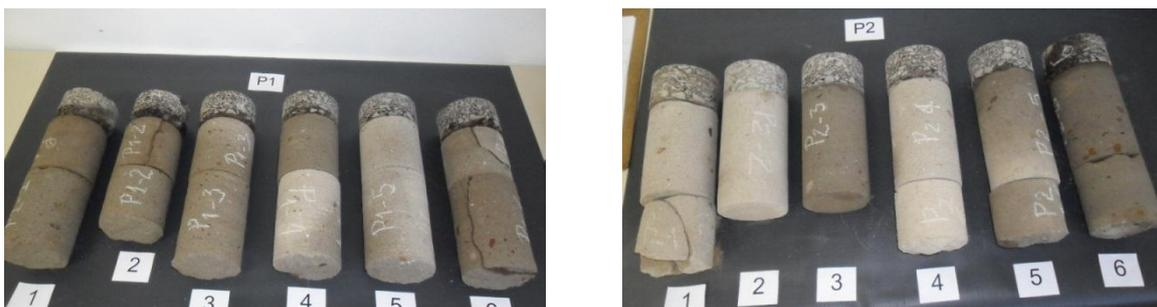
Figura 5.4 - Conjunto de amostras extraídas nos pontos P1 e P2.
