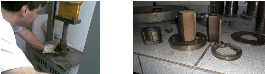
Figura 3.19 – Prensa de moldagem e aspecto de um CP após moldagem.
