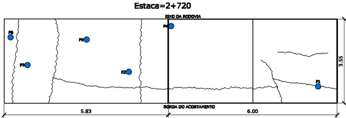
Figura 3.10 – Mapeamento das trincas e localização dos pontos de extração, ponto P5.
