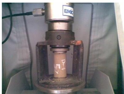
Figura 3.21 – Prensa para ensaios de resistência a compressão simples.
