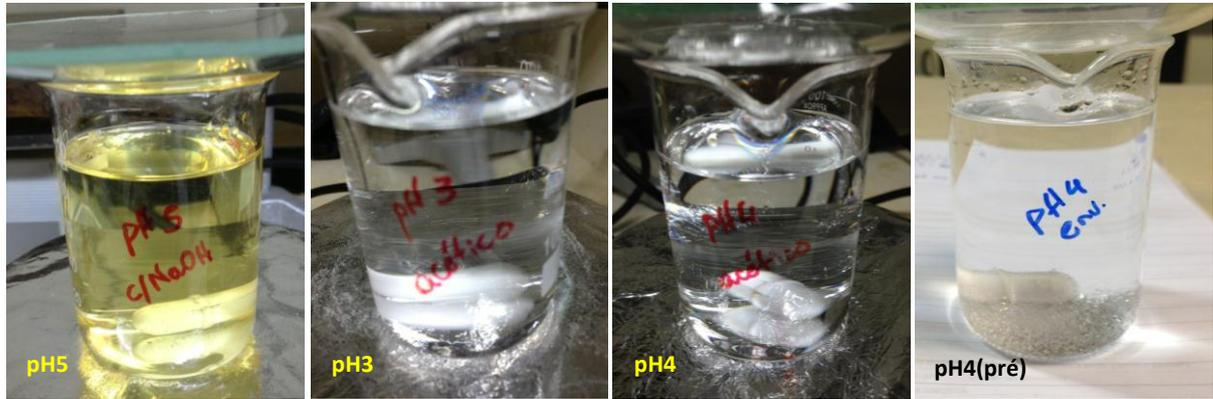
Figura 31 - Soluções após mistura dos três componentes (água+ cério+ álcool) e ajuste do pH.
