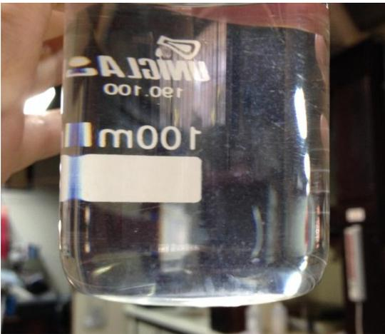
Figura 28 - Solução de água com adição de 0,01M de nitrato de cério após pH atingir 6,4 com adição de NaOH (presença de pequenos precipitados).
