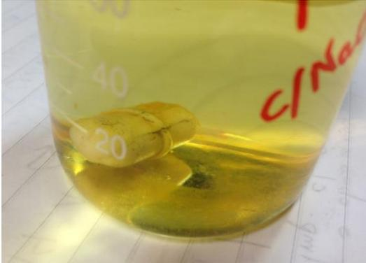
Figura 33 - Solução pH5 após adição do silano e hidrólise de 24h com presença de precipitados.
