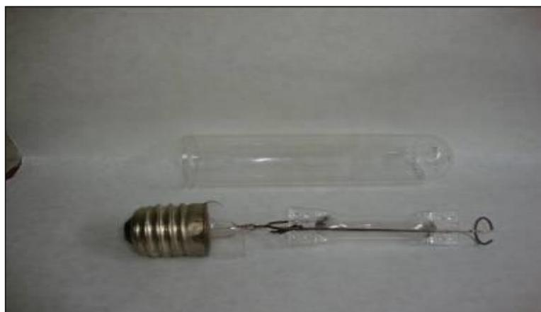
Figura 7- Lâmpada de Vapor de Mercúrio (Philips) de 250 W e Bulbo de quartzo
