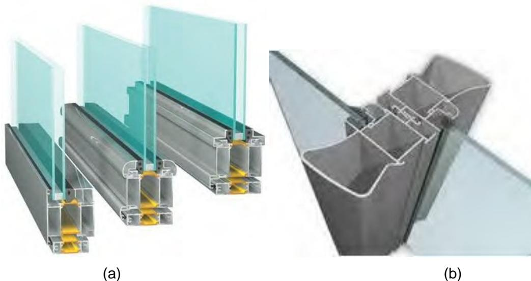
Figura 31: (a) – Perfis de alumínio com quebra de ponte térmica, vendido na Inglaterra (Fonte: Aluminiumdesign.net, 2013); (b) - Perfil de alumínio sem quebra de ponte térmica, vendido no Brasil (Fonte: Alcoa, 2009).
