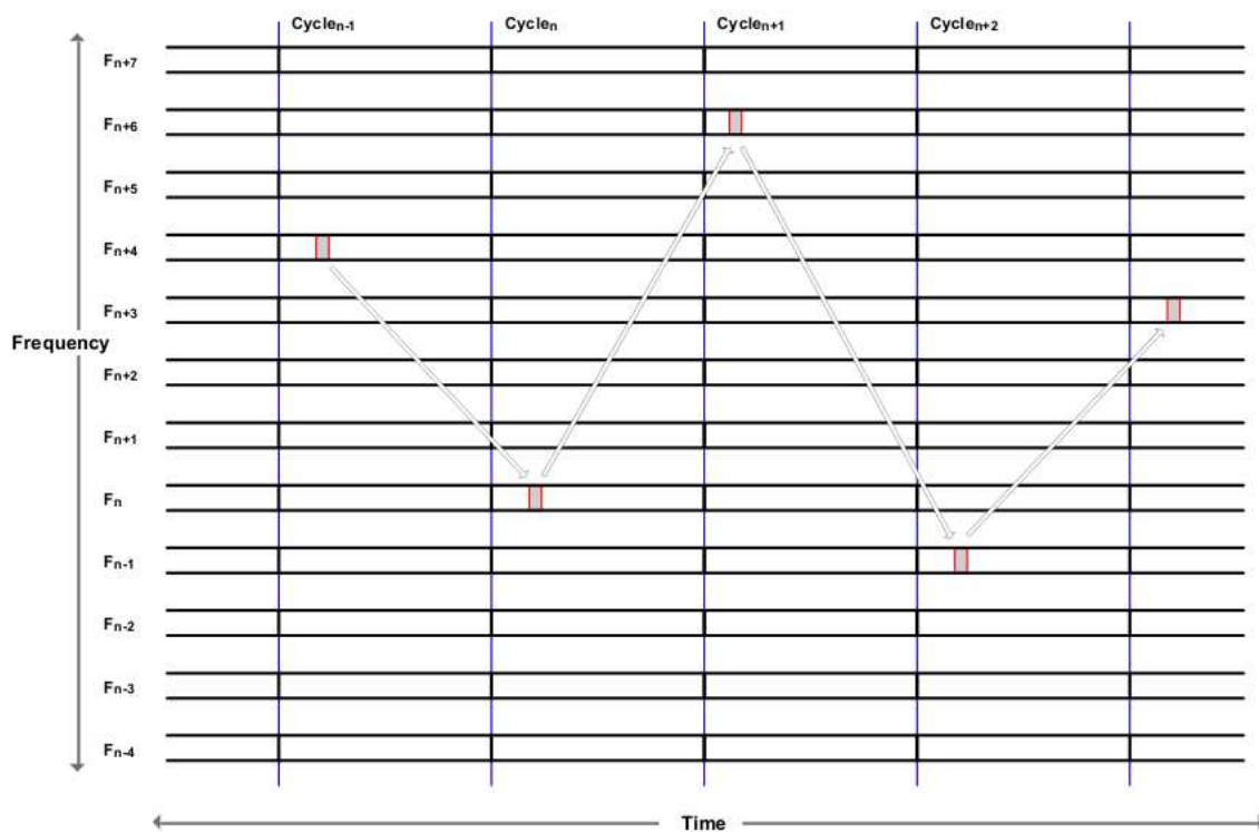
Figura 7: Saltos de frequência no protocolo WirelessHART (HCF SPEC-075 Rev. 1.1)
