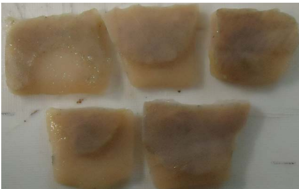
Figura 4.45: Degradação das amostras de peles piqueladas causadas pelo fungo Aspergillus niger
