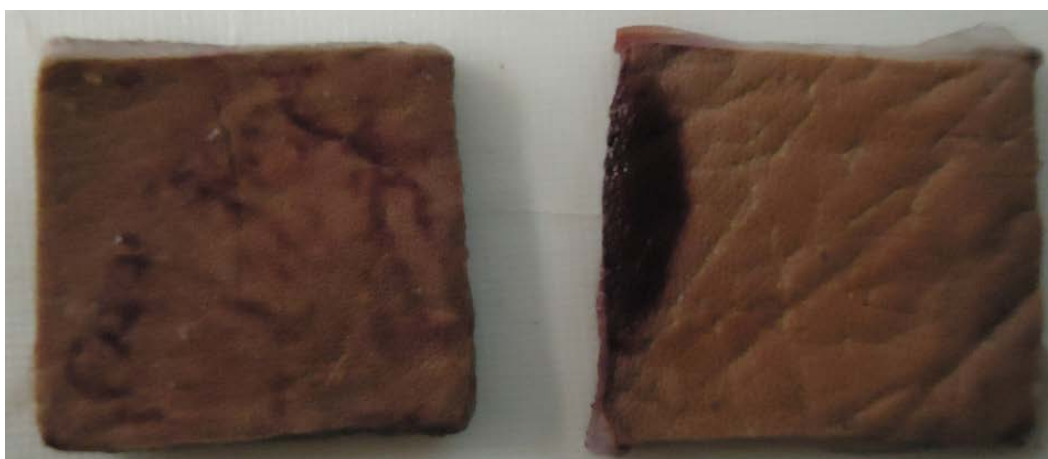
Figura 4.46: Manchas de difícil remoção em amostras de couros curtidos com tanino vegetal causadas pelo fungo Penicillium herguei
