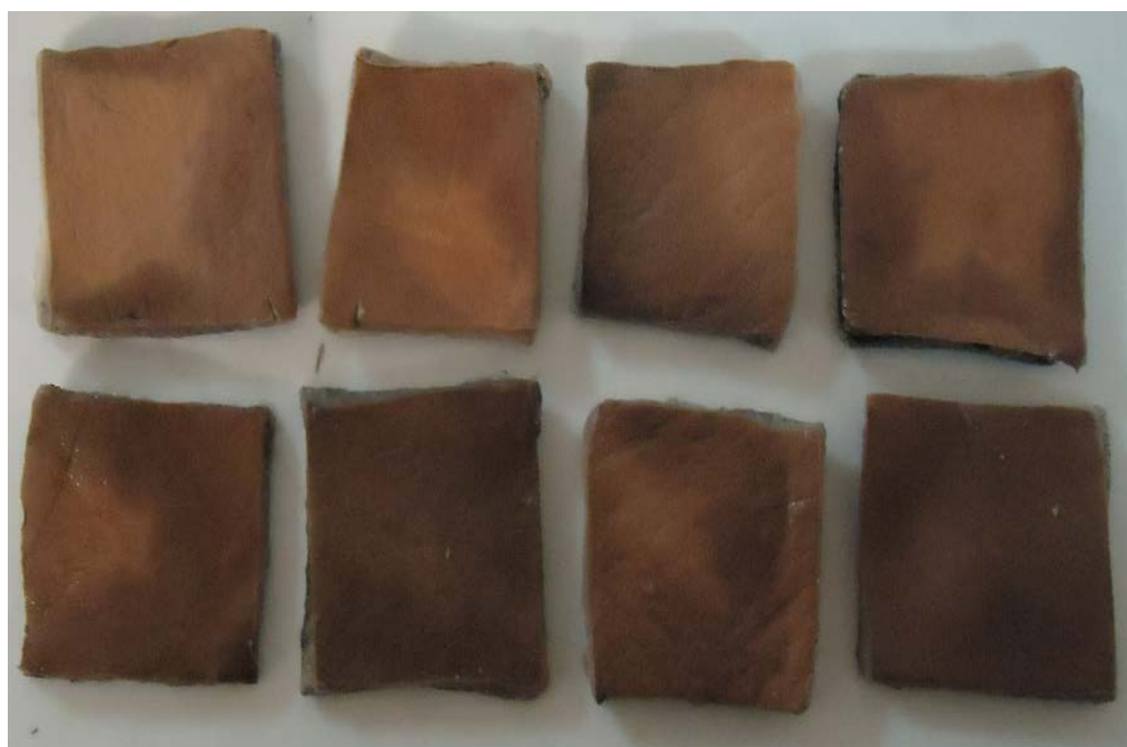
Figura 4.44: Manchas de difícil remoção em amostras de couros curtidos com tanino vegetal causadas pelo fungo Aspergillus niger
