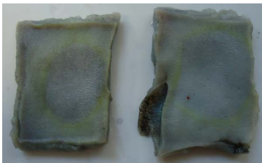
Figura 4.43: Manchas de difícil remoção em amostras de couros wet-blue causadas pelo fungo Aspergillus niger
