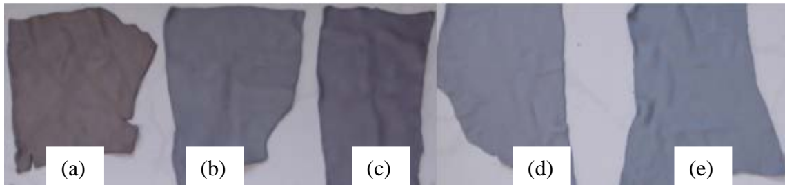
Figura A.4: Couros curtidos com adição de metabólitos secundários (a) Aspergillus niger , (b) Diplódia , (c) Monascus purpureus , e (d) Fusarium graminearum e (e) controle
