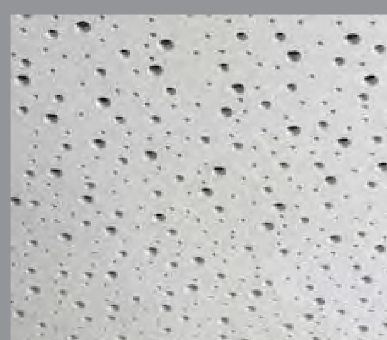
Alvenaria em blocos de concreto celular 600x300x150mm
