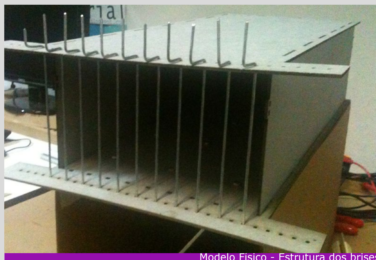
Modelo Físico - Estrutura dos brises
