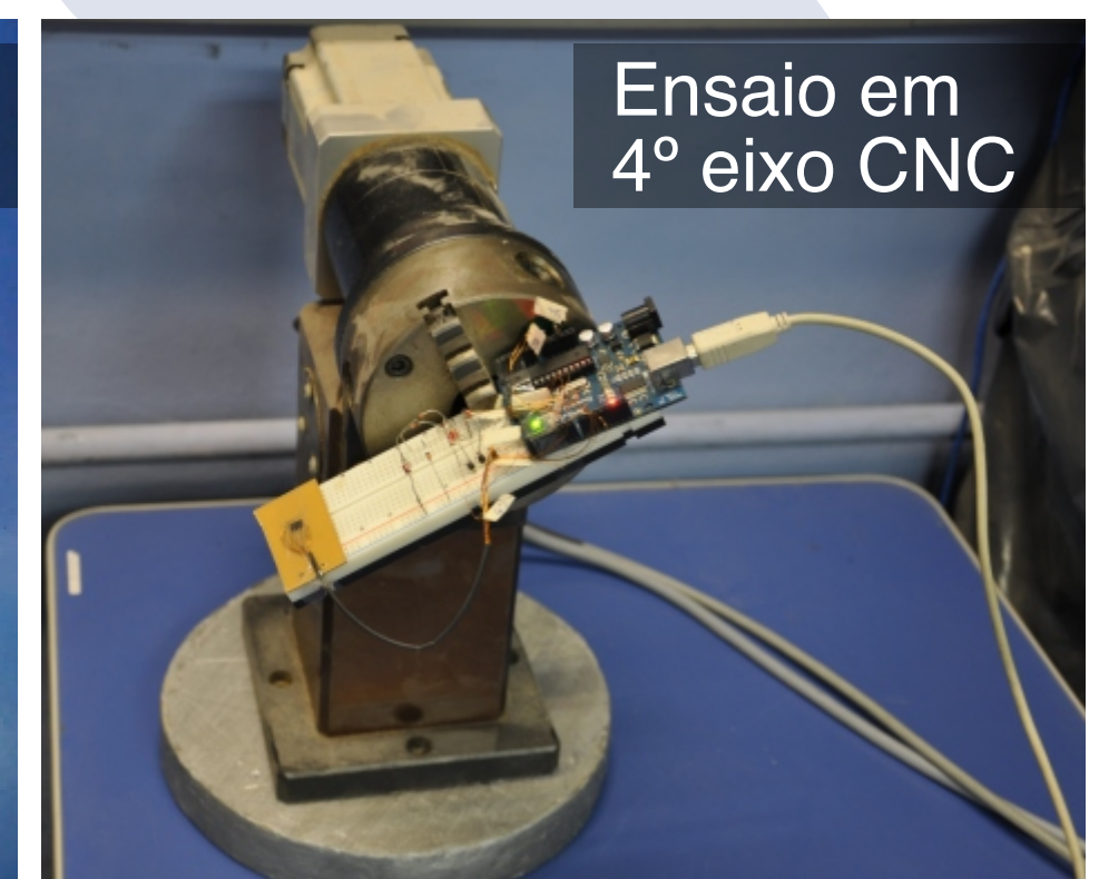
Acelerômetros com Arduinos
