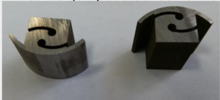
Figura 2 - Células de carga construídas
