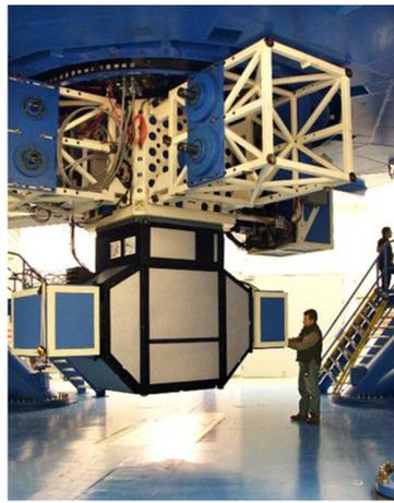
**Figura 3:** Instrumento GMOS-S do observatório Gemini Sul, utilizado para obtenção das fotografias da galáxia NGC 7020
