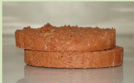
Corpo de prova cisalhado.
