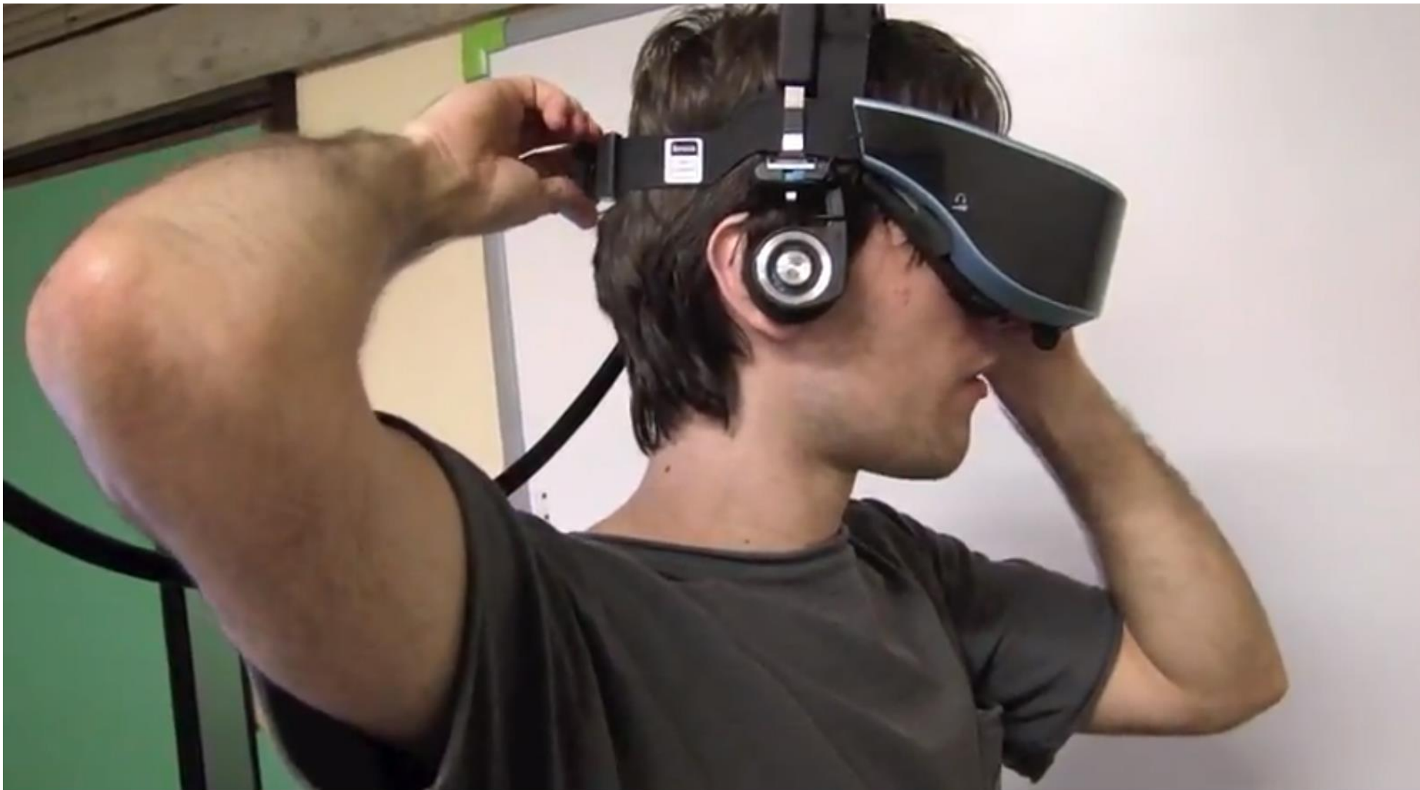
Head Mounted Display responsável pela imersão – visualização, rotação de cabeça e áudio.
