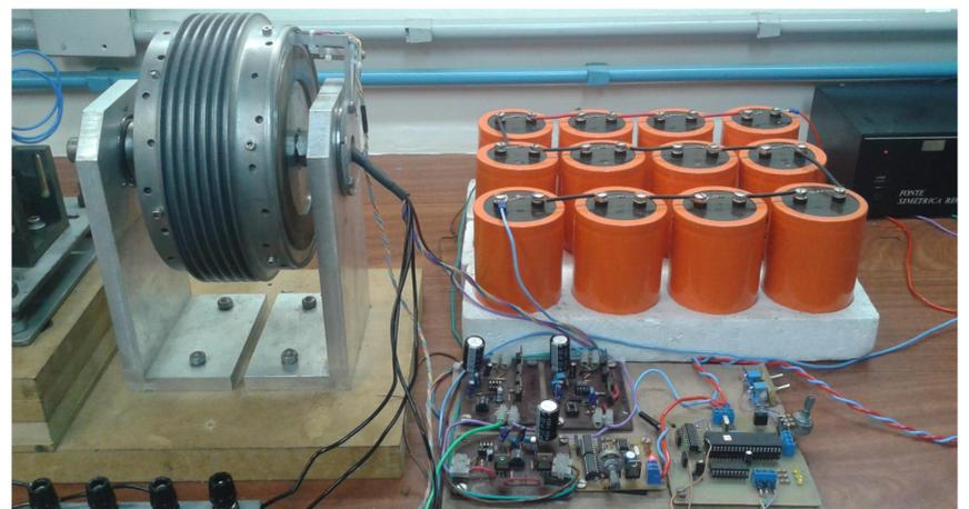
Figura 3 – Máquina Tórus, circuito desenvolvido e banco de capacitores
