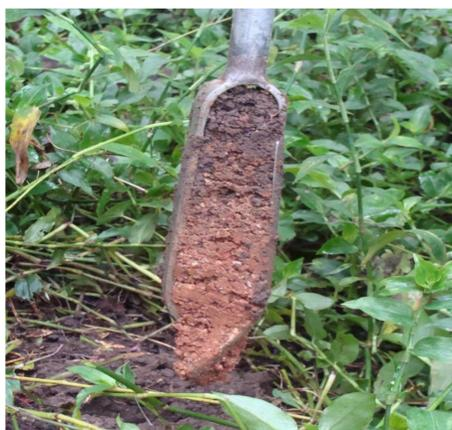
Amostragem de solo, em 2013, repetindo metodologia usada em 2006, utilizando Trado Holandês, e 15 subamostras por amostra.
