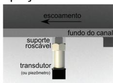
Detalhe da instalação dos transdutores de pressão
