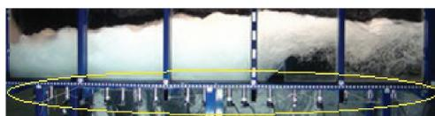
Vista da instalação dos transdutores de pressão junto ao fundo da bacia de dissipação
