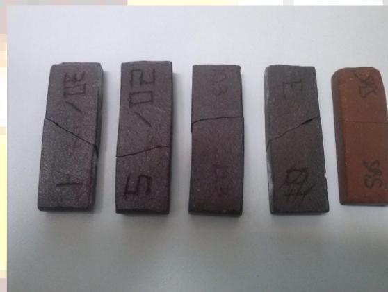
Figura 5. Imagem mostrando a cor de queima dos corpos de prova queimados a 1120°C.
