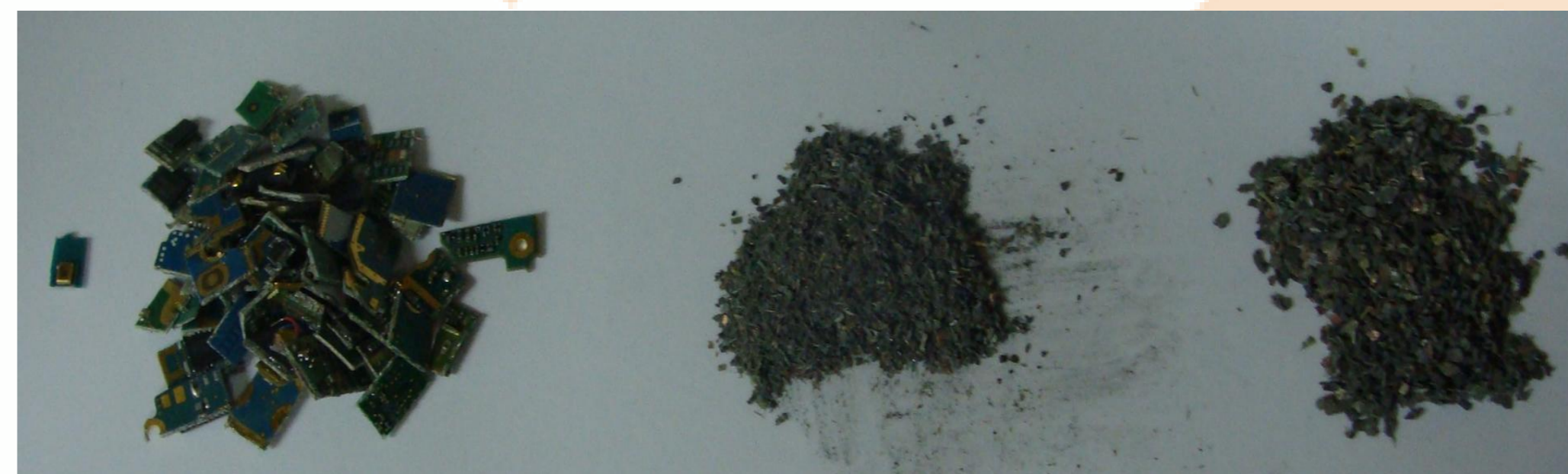
Figura 4 – Resultado final das placas de tamanho 12mm, < 2mm e > 2 mm, respectivamente.
