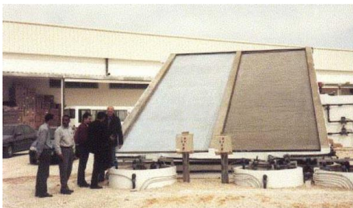
Figura 4 - Planta piloto de uma indústria têxtil na Tunísia composta por dois reatores do tipo placa plana.
