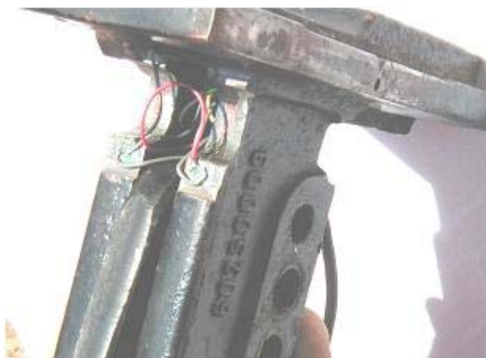
Figura 8. Suporte da haste sulcadora da semeadora-adubadora.
