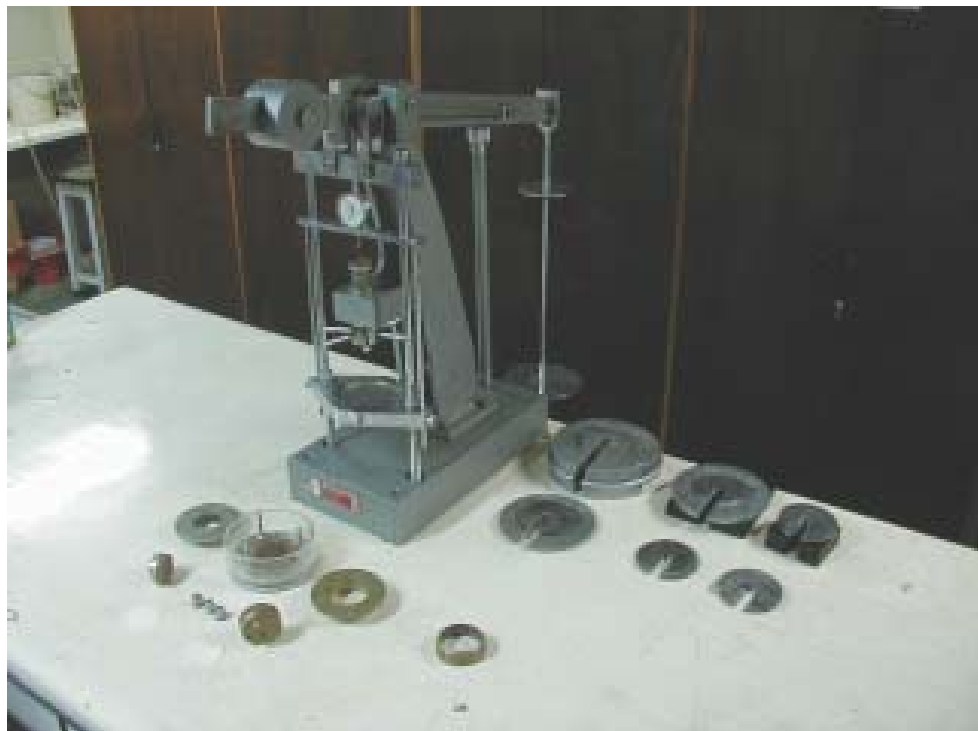
Figura 32. Prensa oedométrica e seus componentes
