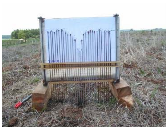
Figura 29. Vista frontal do perfilômetro em uso no campo.
