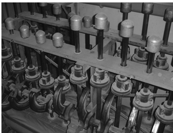
Figura 4.8 – O processo de moagem (soque) (Indústria Ervateira Ximango Ltda. Ilópolis – RS).
