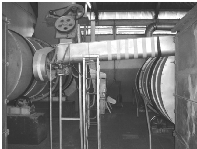
Figura 4.7 - À esquerda, o equipamento utilizado para o sapeco das folhas de erva-mate. À direita, o equipamento utilizado para a secagem da erva-mate. No centro, encontra-se uma esteira que conduz as folhas saídas do sapecador até o secador (Indústria Ervateira Ximango Ltda. Ilópolis – RS).
