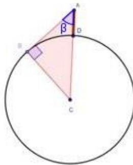
Figura 23 – Modelagem cálculo raio da Terra
