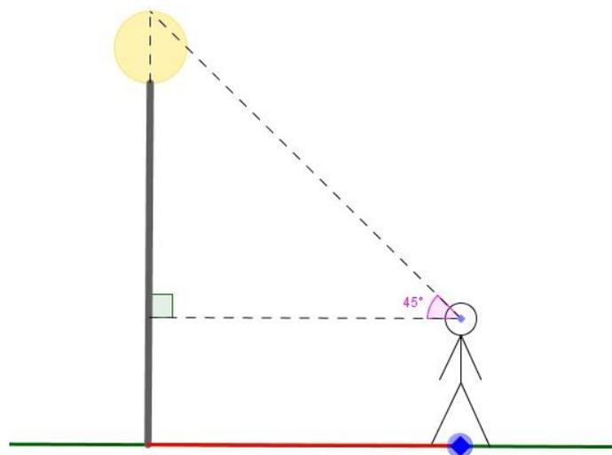
Figura 17 – Modelagem ângulo de visada de  $45^\circ$
