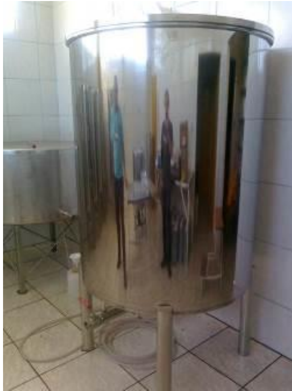
Figura 6: Tanque de decantação e armazenamento
