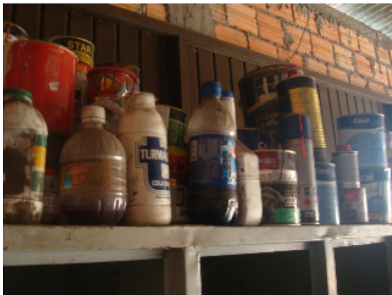
Figura 4.3 – Produtos químicos em embalagens reaproveitadas sem a identificação correta
