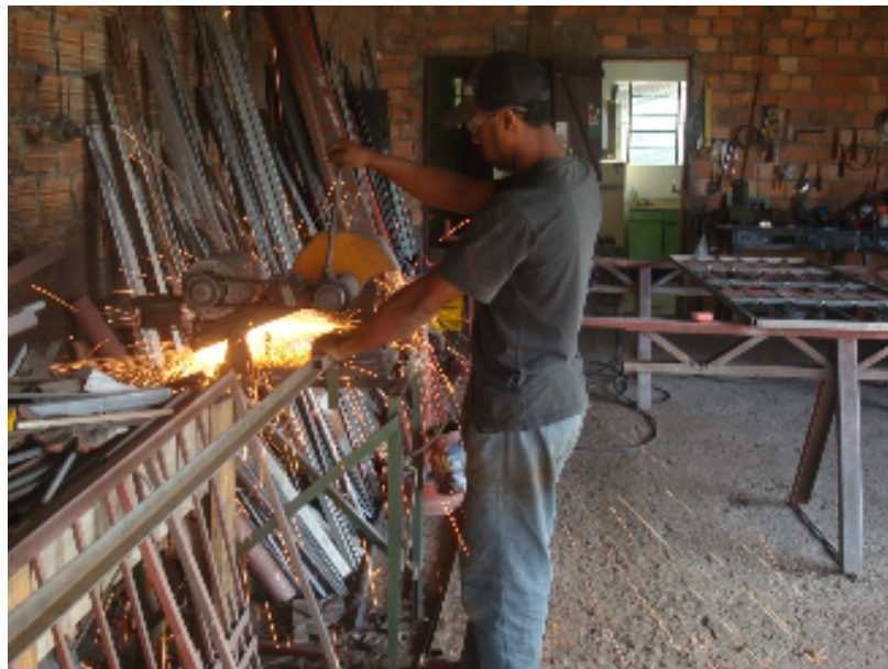
Figura 4.2 – Poli-cortes sem dispositivo de fixação de peças e sem proteção de correias Exposição às vibrações, ruídos e particulados; riscos de queimaduras e cortes.
