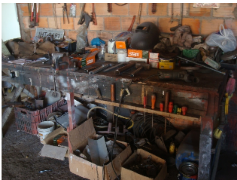
Figura 4.4 – Condição do ambiente de trabalho sem a aplicação da ferramenta 5Ss
