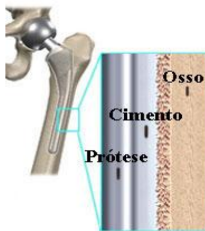
Figura 2 – Desenho esquemático de prótese total de quadril cimentada.
