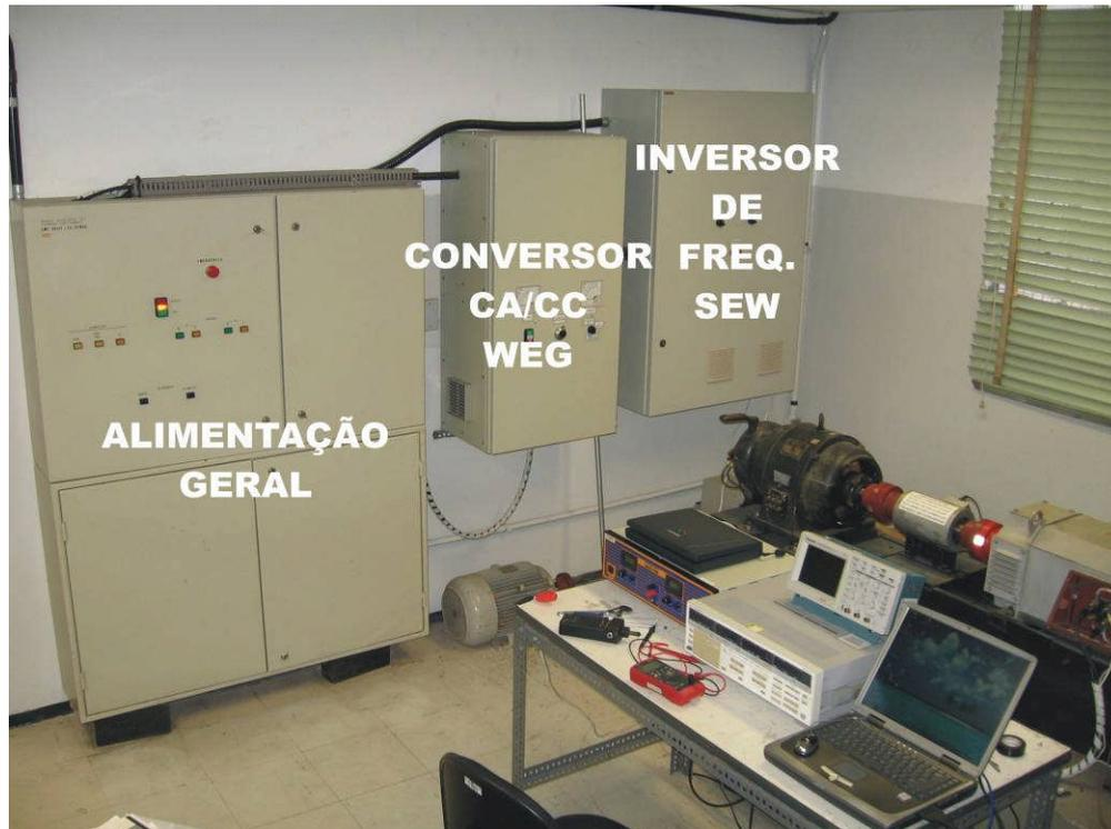
**Figura 71 – Foto da bancada de testes do GEADA e quadros de comando do motor CC e do inversor de frequência.**
