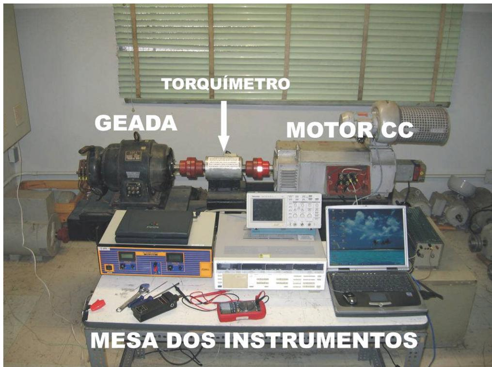
**Figura 70 – Foto da bancada de testes do GEADA.**
