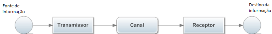
Figura 3 Diagrama de bloco de um sistema de comunicação. (HAYKIN, 2008)
