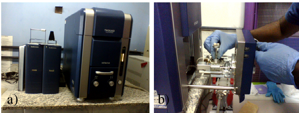
Figura 3.11: análises de MEV-EDS dos clínqueres CSAB experimentais: a) equipamento; e b) colocação de amostras para análise
