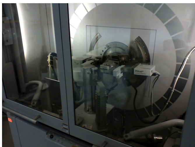
Figura 3.9: equipamento utilizado para coleta dos difratogramas para análise quantitativa de fases dos clínqueres experimentais
