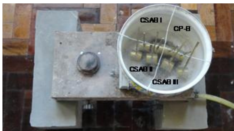
Figura 3.14: execução do ensaio de expansibilidade a quente
