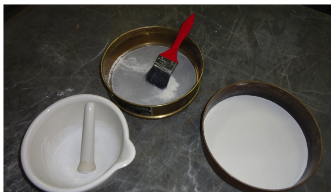
Figura 3.6: moagem do resíduo de anodização seco em estufa com auxílio de almofariz e passado na peneira de abertura 75 \mu\text{m}
