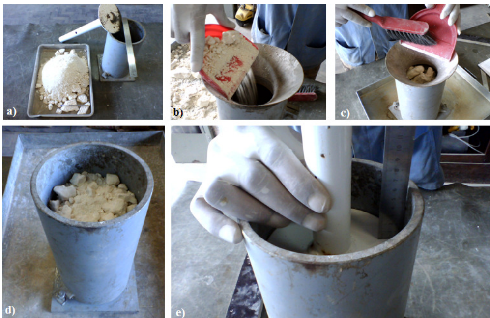
Figura 3.5: procedimento para determinação da massa unitária do resíduo – a) resíduo e ferramentas; b) resíduo sendo vertido para o recipiente; c) finalização da etapa anterior; d) cilindro preenchido com o resíduo; e e) determinação da altura alcançada pela amostra
