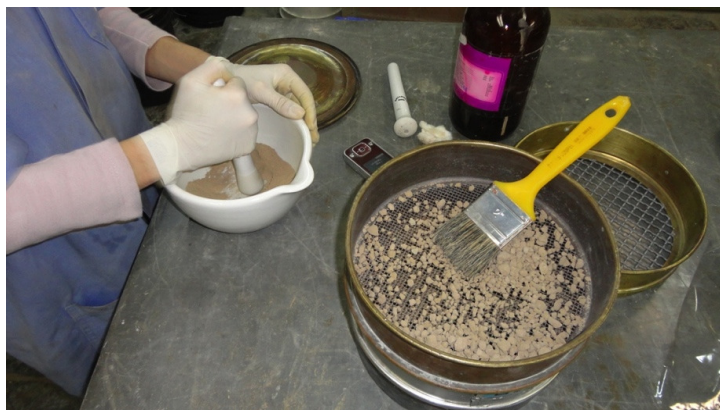
Figura 3.8: procedimento de moagem dos clínqueres CSAB experimentais para obtenção do cimento
