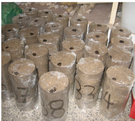
Figura 3.21. Cura de corpos-de-prova em câmara úmida
