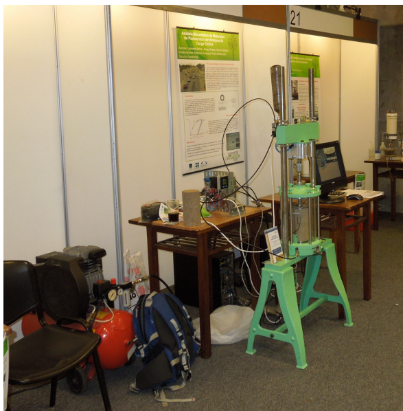
Figura 5.10. Vista geral do equipamento de ensaios de carga repetida na compressão triaxial construído na Sección Geotécnica da UdelaR
