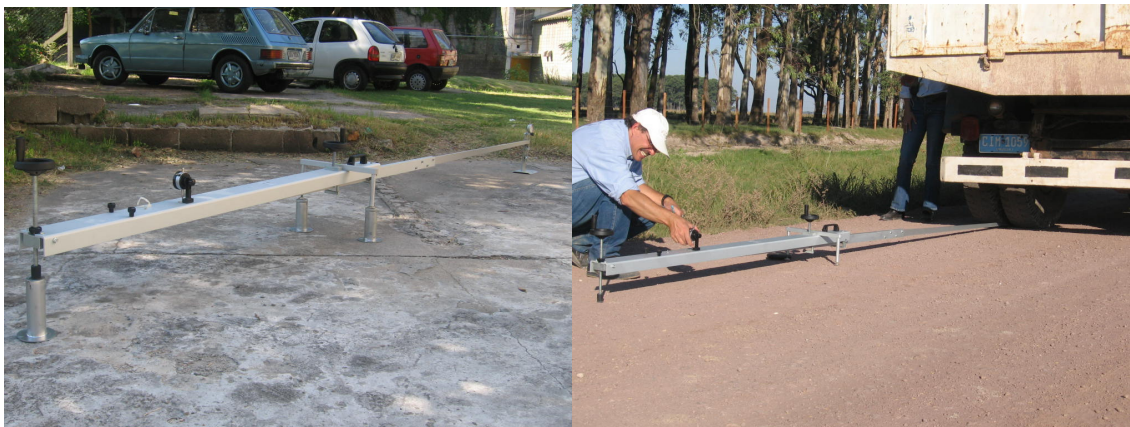
Figura 3.8. Levantamentos deflectométricos com Viga Benkelman
