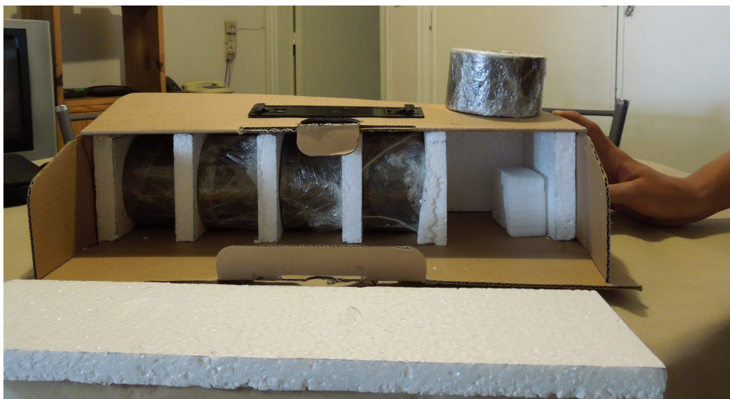
Figura 3.10. Sistema para transporte dos corpos-de-prova para os ensaios de fadiga
