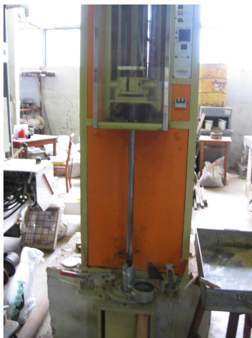
Figura 3.6. Compactador mecânico da Sección Geotécnica da UdelaR
