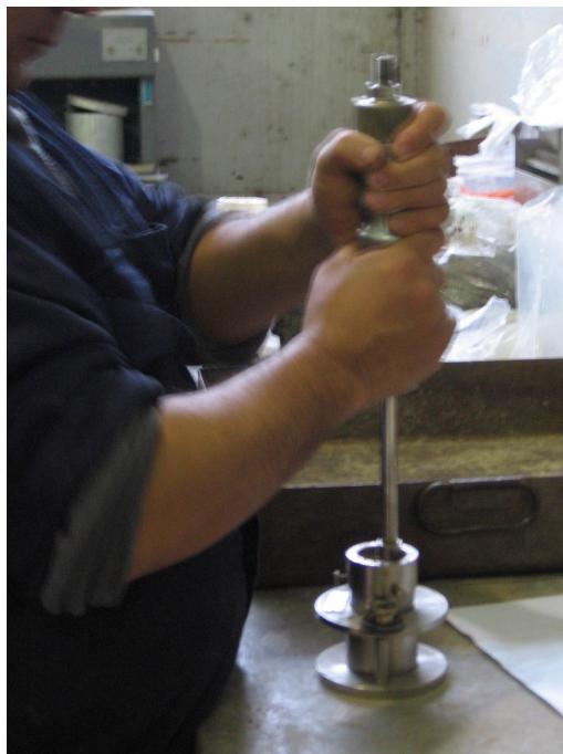
Figura 3.7. Sistema de compactação Mini-Harvard
