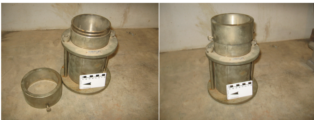
Figura 3.9. Molde de compactação de corpos-de-prova para ensaios de carga repetida na compressão triaxial
