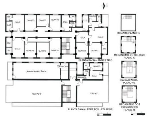
Fig. 314 – Edifício e Cinema Avenida. Plantas baixas pavimento tipo, Terraço e Torre.
