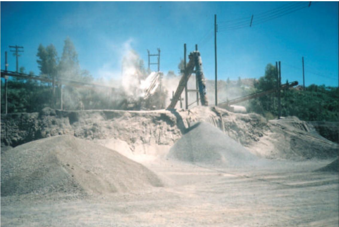
Figura 27 Foto Emissão de Poeira na Instalação de Britagem
