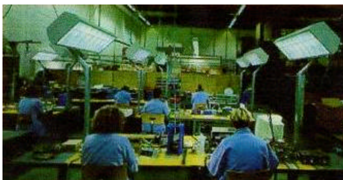
Figura 52: Exemplo de posto de trabalho com iluminação proposta (adaptado de AMARAL, 2004)
