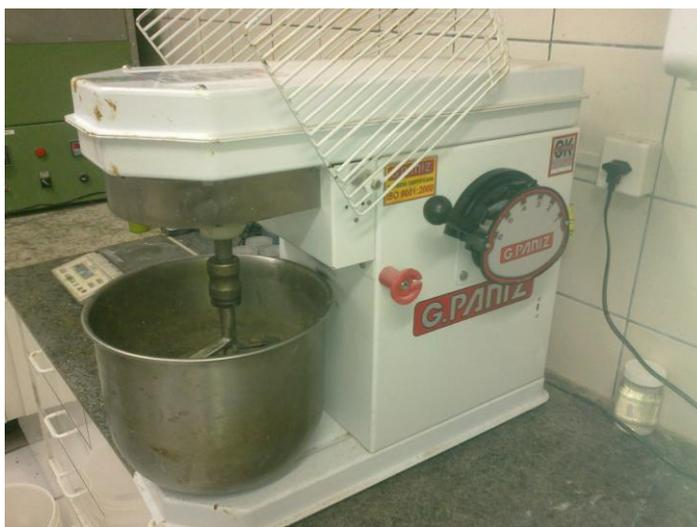
**Figura 21: Misturador planetário utilizado no preparo dos corpos-de-prova para cura a frio.**
