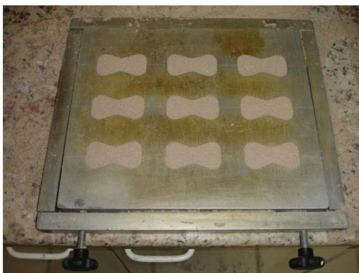
**Figura 22: Gabarito para corpos-de-prova de resistência mecânica à tração.**
