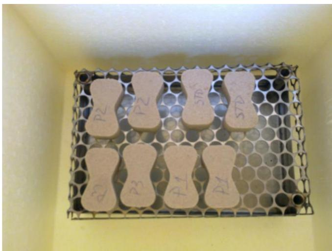
**Figura 24: Corpos-de-prova em câmara úmida de acordo com a CEMP 162**
