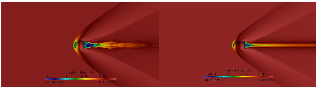
(e)  $\rho v_1$  - velocidade em  $x_1$ (f)  $\rho v_1$  - velocidade em  $x_1$
