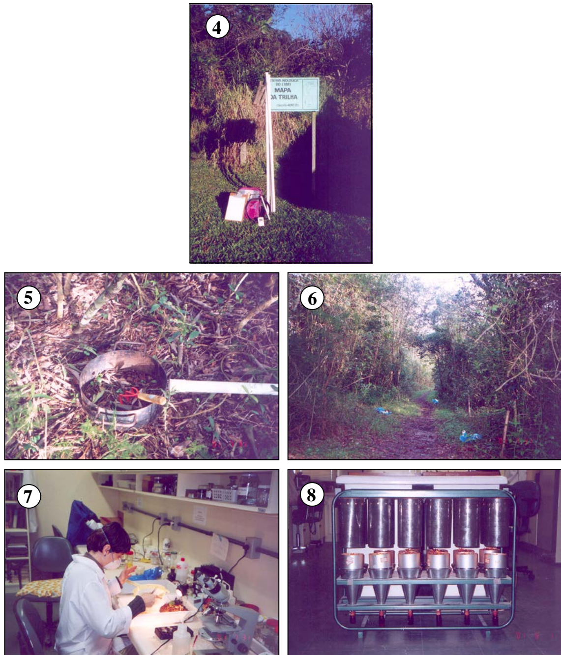
Figs. 4-8. Amostragem e tratamento das amostras. (4) Início da trilha e material utilizado durante as amostragens; (5) amostrador; (6) acondicionamento das amostras ao longo da trilha; (7) triagem das amostras em laboratório; (8) extração dos animais através do Funil de Berlese.
