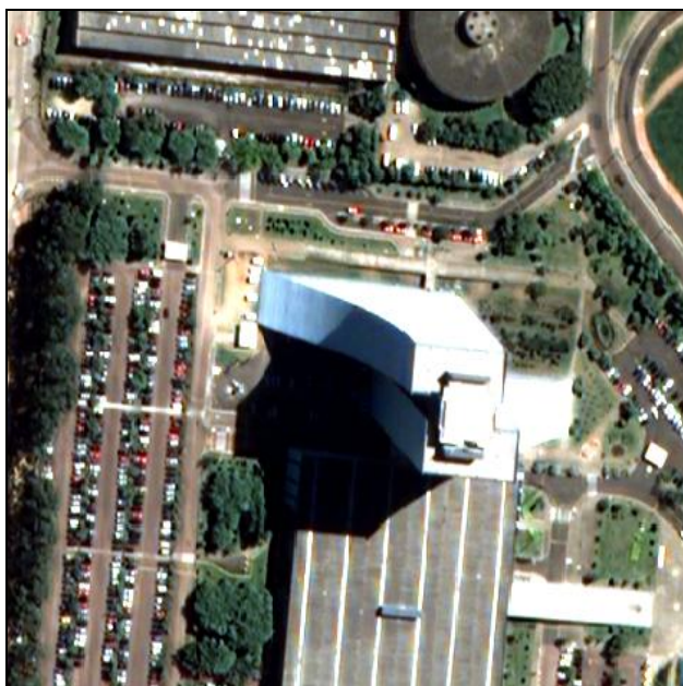
Figura 19 – Inclinação dos edifícios devido ao deslocamento da órbita do satélite.
