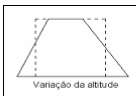
Figura 3- Distorção causado pela variação de altitude. (Fonte: Adaptado de RICHARDS, 1999)
