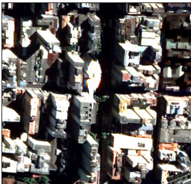
Figura 18 – Exemplo de alta reflectância dos materiais que compõe o telhado das edificações
