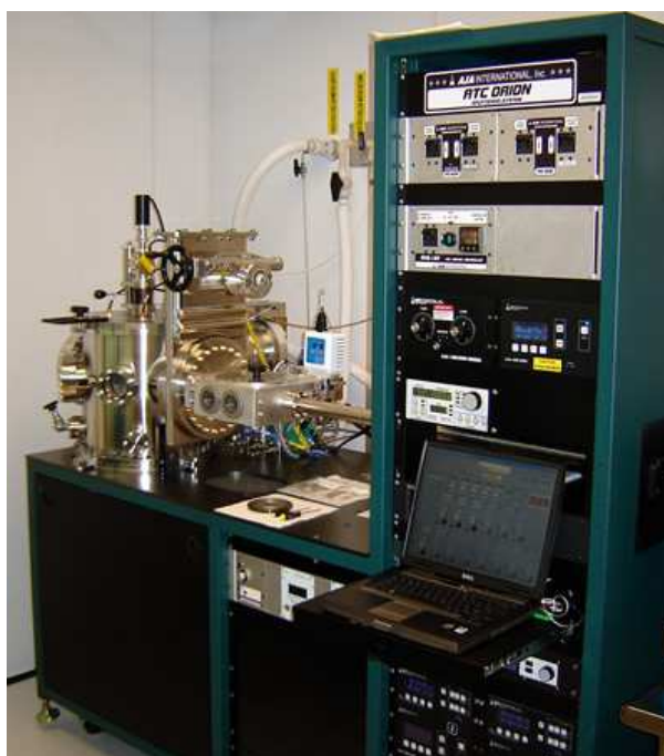
Figura 3.3: Equipamento Orion-8 UHV da empresa AJA Internacional Inc. utilizado para as deposições por sputtering nesse trabalho.
