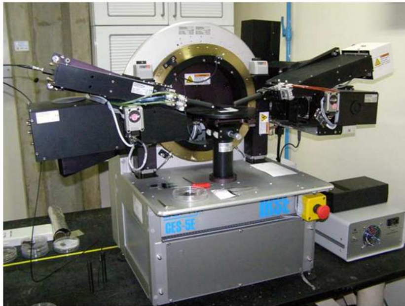
Figura 3.7: Elipsômetro SOPRA GES-E utilizado para caracterização.
