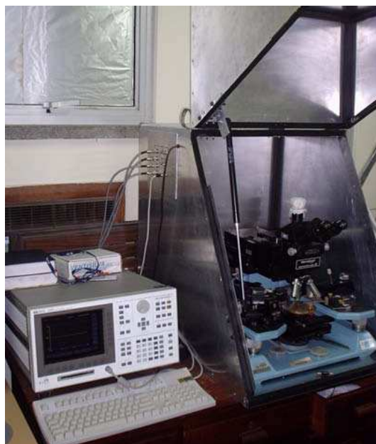
Figura 3.17: Visão geral do sistema de medidas I \times V : blindagem, Analisador de Parâmetros Semicondutores HP4155A e sistema de posicionamento de ponteiros.
