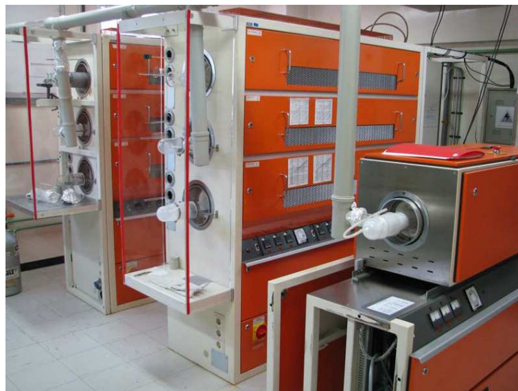
Figura 3.1: Para processos térmicos, o L \mu E possui dois fornos para oxidação, úmida e seca, fornos para dopagem e difusão de dopantes, forno para recozimento dos estados de interface, forno de SiC (carbeto de silício) para recozimentos em altas temperaturas e um forno para deposição de poli-silício.
