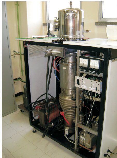
Figura 3.4: Evaporadora resistiva utilizada para deposição de alumínio. Equipamento do Laboratório de Microeletrônica do IF-UFRGS.
