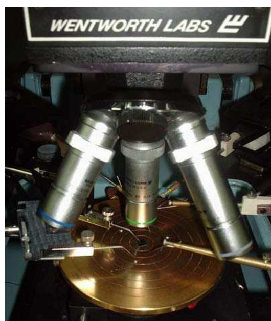
Figura 3.19: Em detalhe, o sistema e posicionadores de precisão com agulhas de tungstênio.
