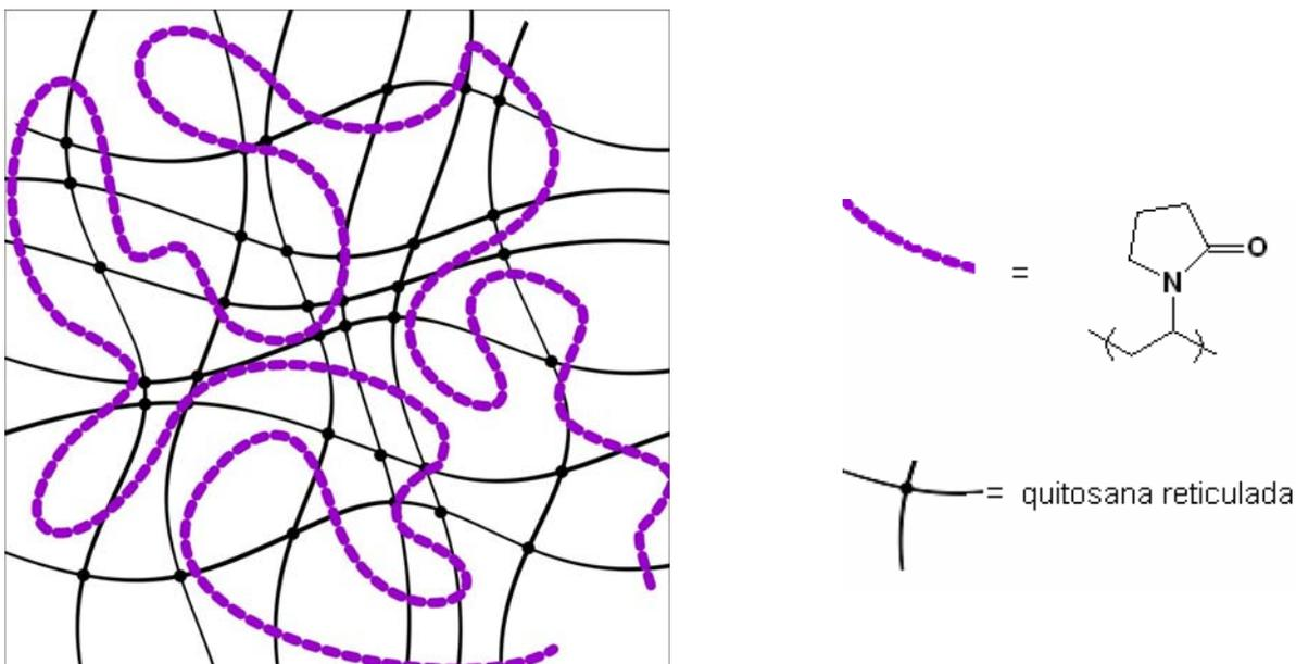
Figura 22: Representação esquemática de uma semi-IPN composta de PVP/QUI.
