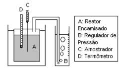
a temperatura do reator como função do tempo. Os parâmetros do modelo cinético proposto foram obtidos a partir de um reator construído em escala de bancada, esquematizado na figura.
