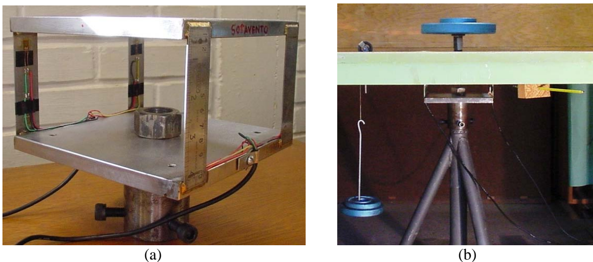
Figura 3.19: Balança de força unidirecional: (a) detalhe da instrumentação; (b) instalação sob a base do túnel de vento.
