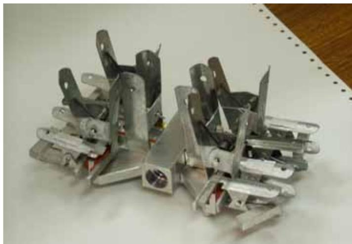
**Figura 4.28** Dispositivos de fixação para pressionar os sensores
