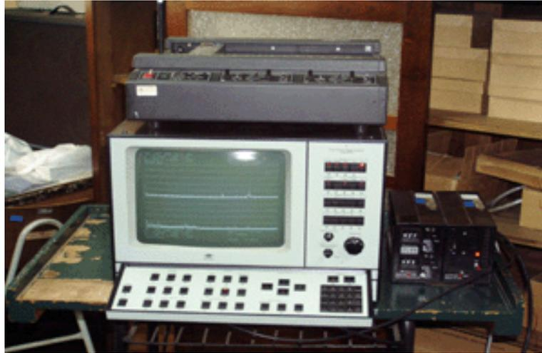
**Figura 4.30** Sistema de medição composto por um analisador de Fourier, registrador analógico e amplificadores.
