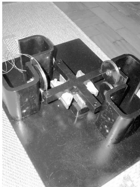
**Figura 4.33** Dispositivo de calibração, base de fixação, pedal e dispositivo de transferência de carga.
