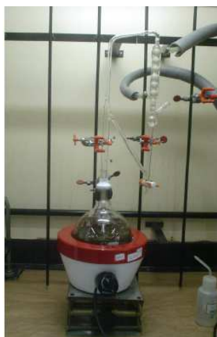
Figura 23. Fotografia do aparelho de Clevenger durante o processo de hidrodestilação das folhas de alcachofra.
