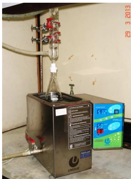
Figura 17. Fotografia do banho de ultrassom utilizado na extração das folhas de alcachofra.
