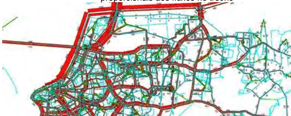
Figura 2.24 – Visualização parcial da rede viária metropolitana adotada pelo PITMURB e respectivo carregamento. As espessura das faixas avermelhadas são proporcionais aos fluxos no trecho
