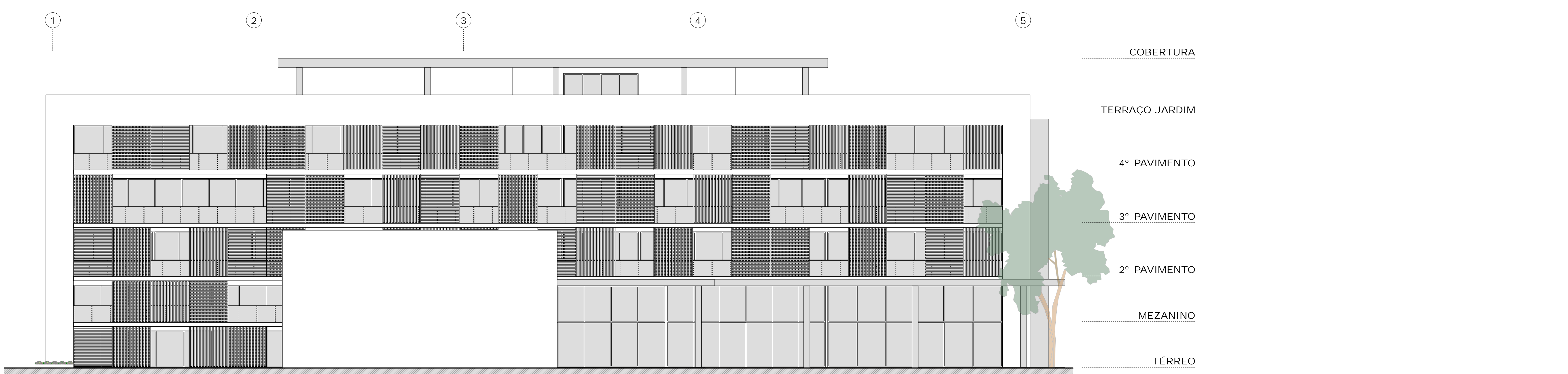
FACHADA LESTE - COM BRISES PARCIALMENTE ABERTOS ESCALA 1:125
