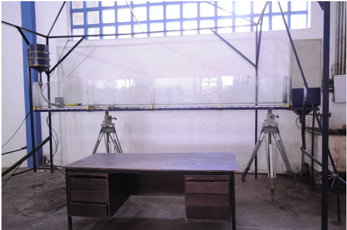
Figura 4.8: Canal Unidimensional de Pequenas Dimensões empregado nos ensaios preliminares.
