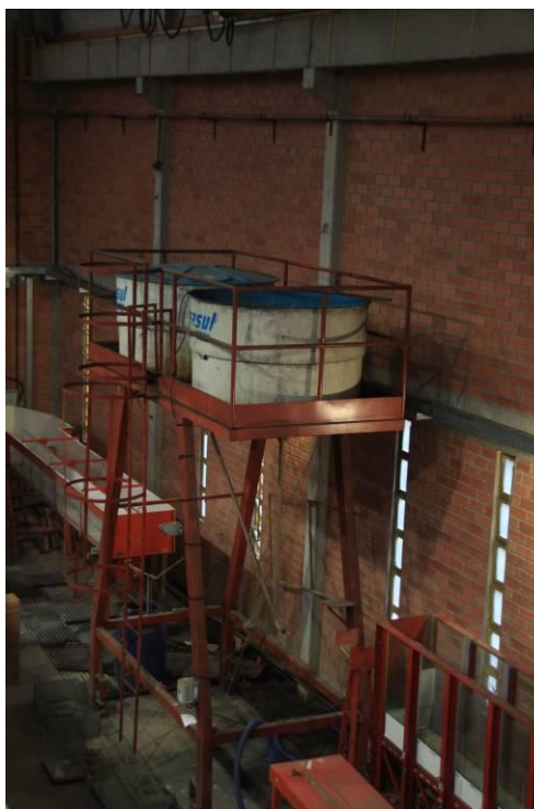
Figura 4.3: Reservatório (no primeiro plano da fotografia) para a alimentação dos ensaios.
