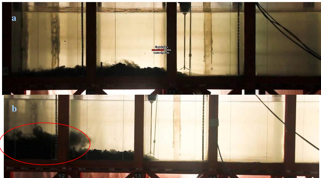
Figura 6.2: a) corrente do ensaio E_6 (seção do difusor plena) e b) corrente do ensaio E_7 (seção do difusor reduzida). Em destaque o aumento da espessura da corrente.
