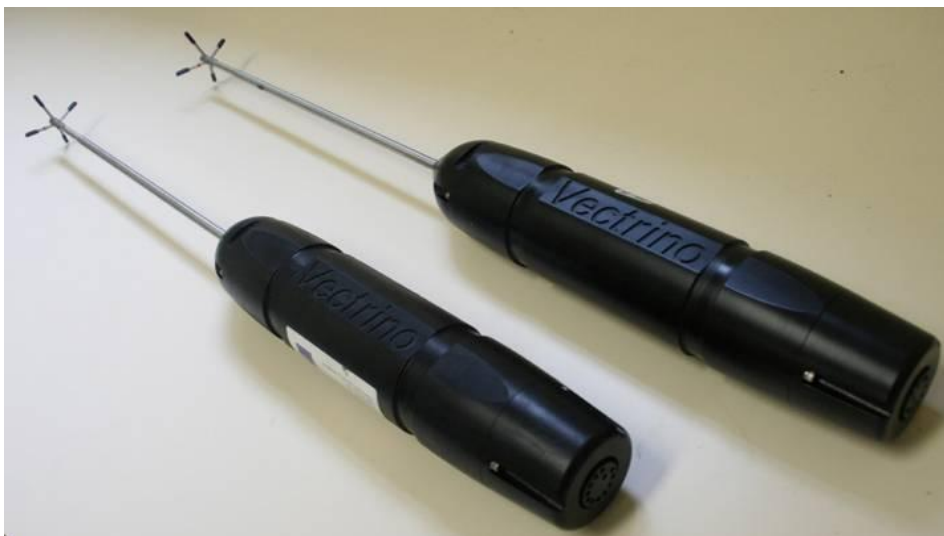
Figura 4.6: Medidores de velocidade por ultrassom Vectrinos.
