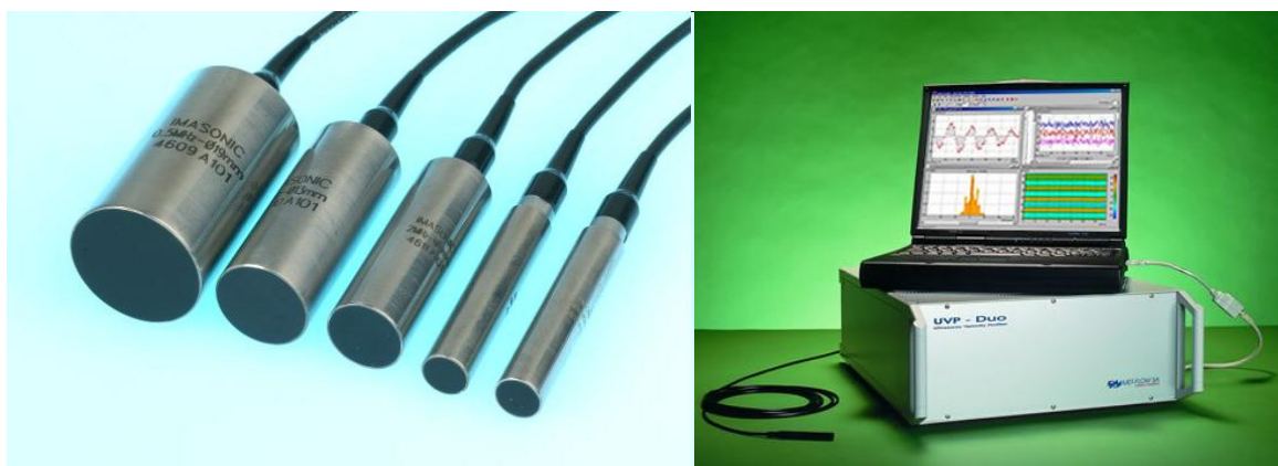
Figura 4.7: Conjunto UVP (manual – Met-flow).
